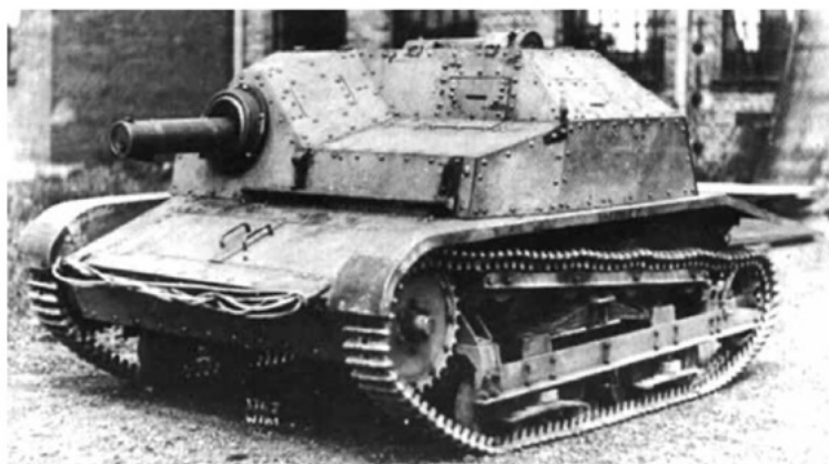
▲ Het TKS prototype nr.1160. Let op het TK-3 onderstel, het wz.30 (Browning) machinegeweer, een hoge uitlaat en geen periscopioep.
